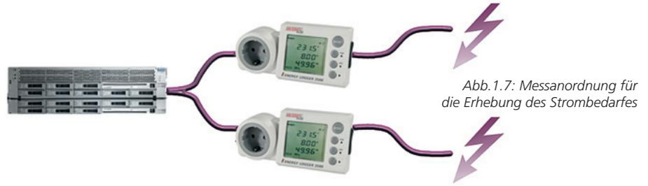
Abb.1.7: Messanordnung für die Erhebung des Strombedarfes
